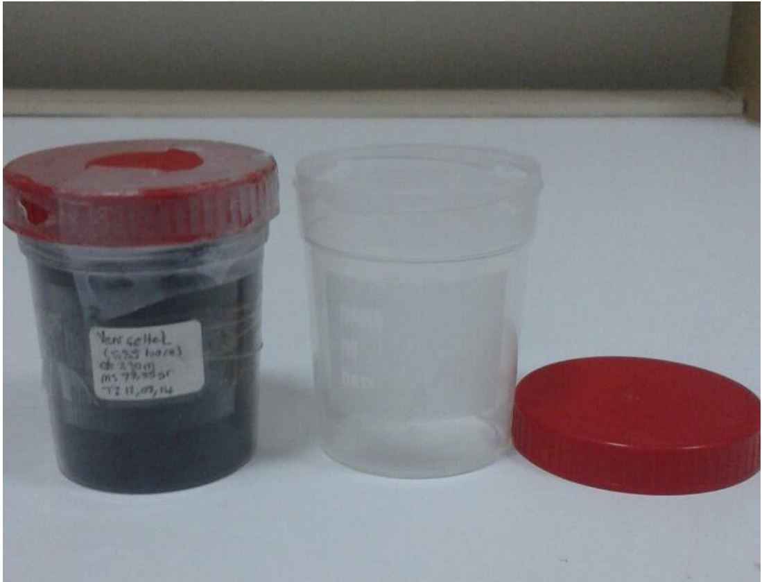
Şekil 4.1. Boş numune kabı ve doldurulup tartılmış, ağzı sıkıca kapatılmış numune kabı
