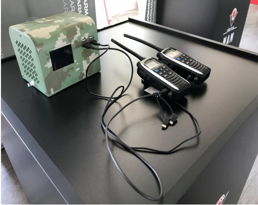
Resim 5.5. Yakıt pili güç kaynağı sistemi [78]
