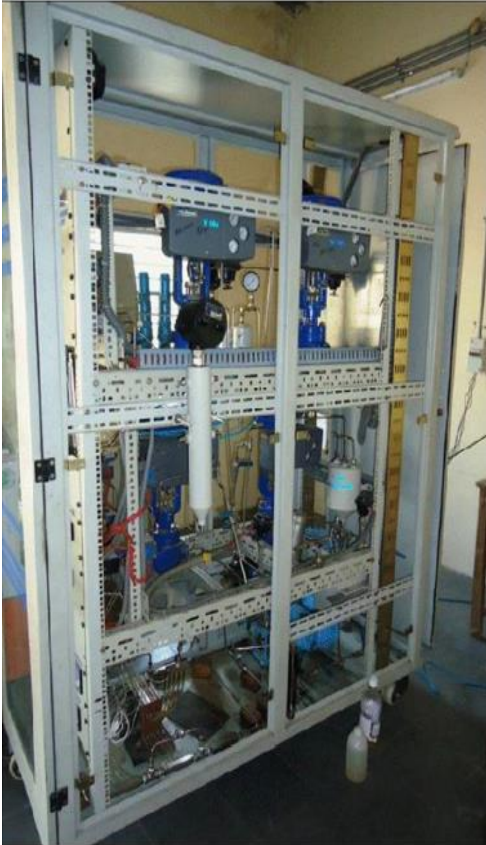
Resim 2.1. PEM elektrolizör sistemi [11]
