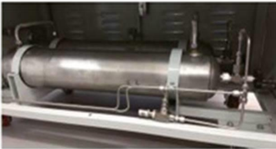
Resim 2.2. G-S hibrit hidrojen depolama sistemi [16]
