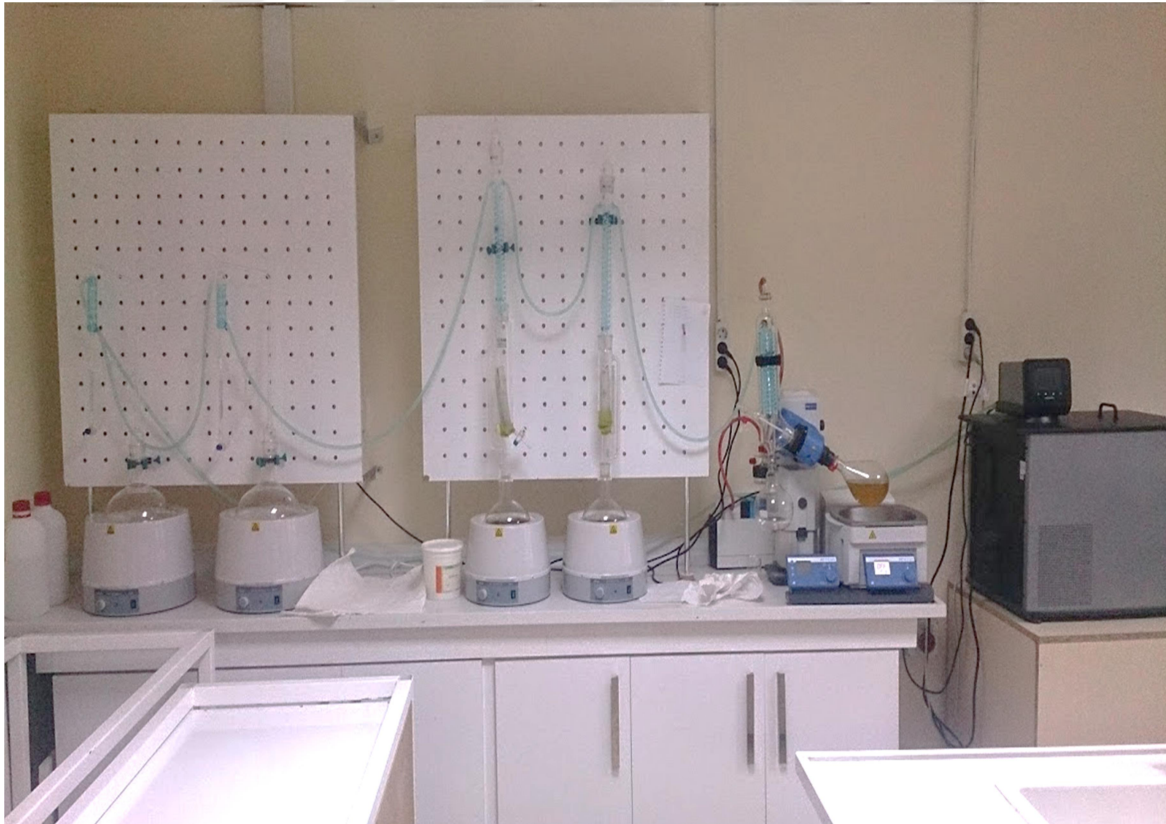
Resim 3.4. Bitki ekstraksiyonu için hazırlanmış Soxhlet düzeneği
