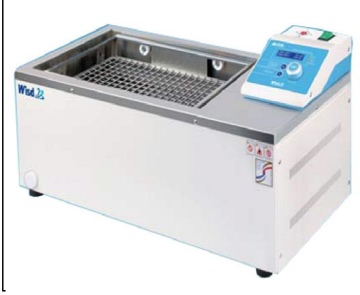
Resim 3.5. Bakterileri büyütmek için WiseBath (Feedback Control Digital Timer Function) su banyosu
