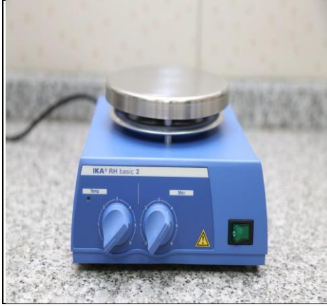
Resim 3.11. IKA RH basic 2 ısıtıcılı manyetik karıştırıcı
