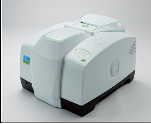
Resim 3.2. Fonksiyonel grupları görüntülemek için Perkin Elmer Frontier FT-IR Spektrofotometresi (Infrared Spektrum)
