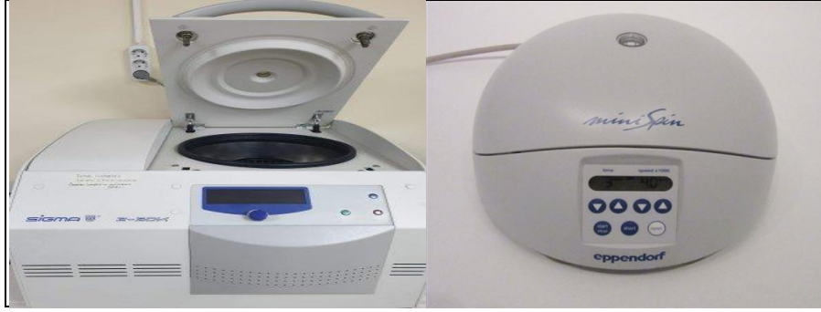
Resim 3.17. Antioksidan aktivite analizi için Sigma 3-30K / 3-30KH çok amaçlı soğutmalı santrifüj ve Eppendorf 5452 Minispin Centrifuge
