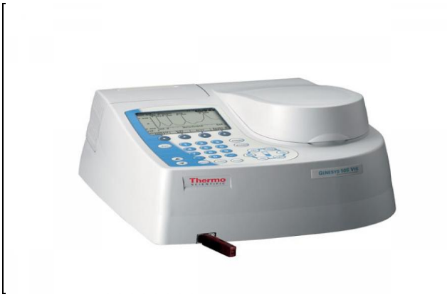
Resim 3.7. Standart grafiklerin oluşturulmasında ve örnek çözeltilerinin absorbanlarının ölçülmesinde Genesys 10S UV-VIS spektrofotometre
