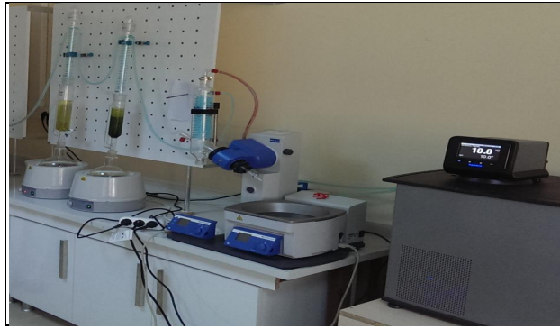
Resim 3.18. Bitki ekstraktlarını hazırlamak için Heating Mantle MS-E mantolu ısıtıcı, Rotary Evaporatör ve Cooling System Status soğutma sistemi
