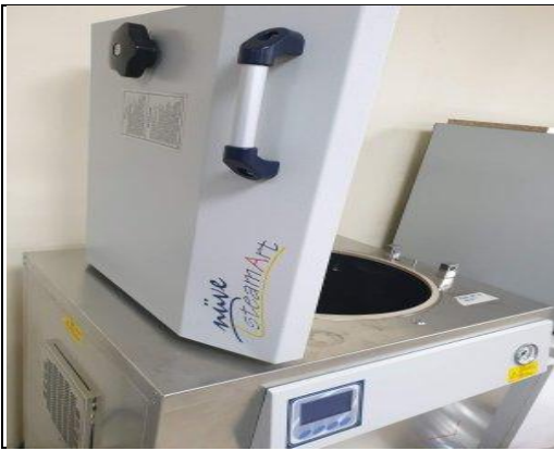
Resim 3.4. Antimikrobiyal aktivite analizlerinde sterilizasyon için Nüve Steam Art (OT-106) otoklav
