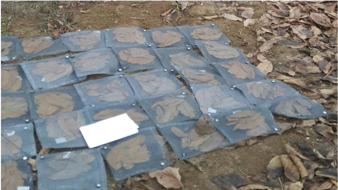
Resim 3.8. Litter paketlerinin 0 cm'lik litter tabakasına yerleştirilmesi
