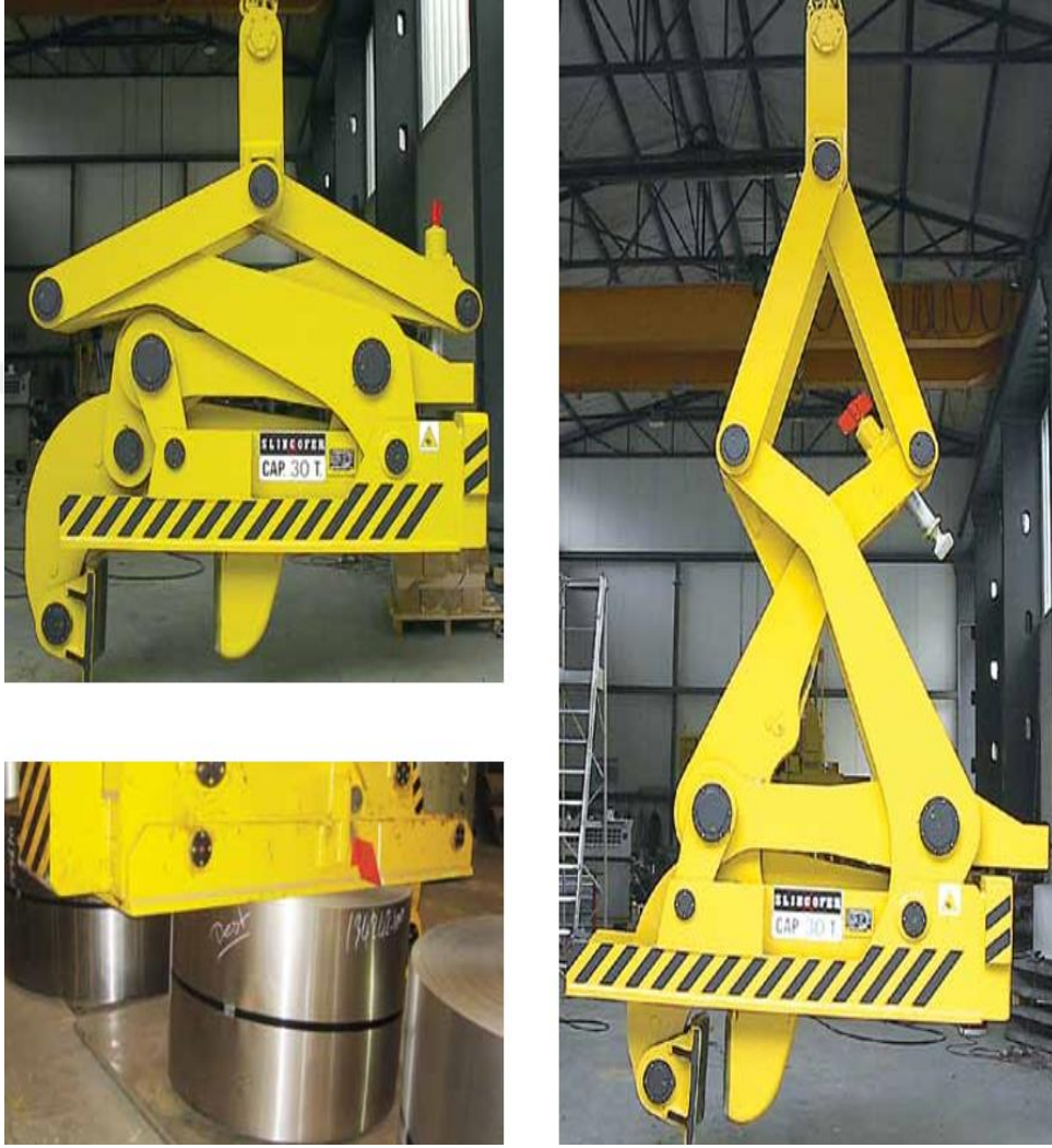
Şekil 3.2. Tek çeneli dikey sac rulo bobin taşıma tongu kapalı ve açık pozisyon aşamalarının gösterilmesi [23]
