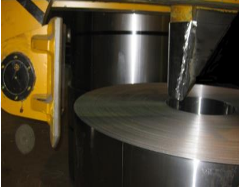
Şekil 3.1. Tong iç çenesinin bobin iç çapına girme aşaması
