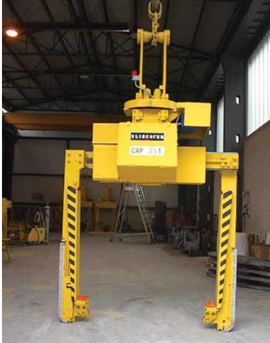
Şekil 2.10. Elektromekanik yatay sac rulo bobin taşıma tongu [23]
