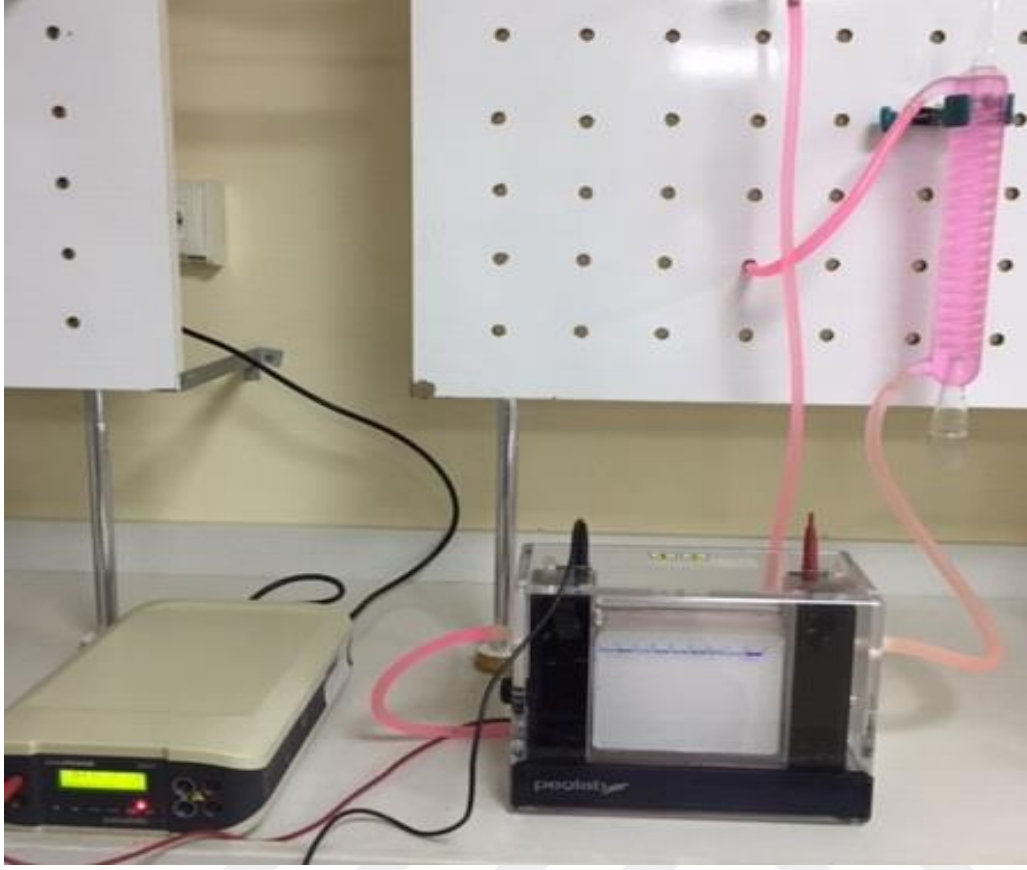
Resim 3.8. Zimogram analizi için hazırlanan dikey jel elektroforezi düzeneği
