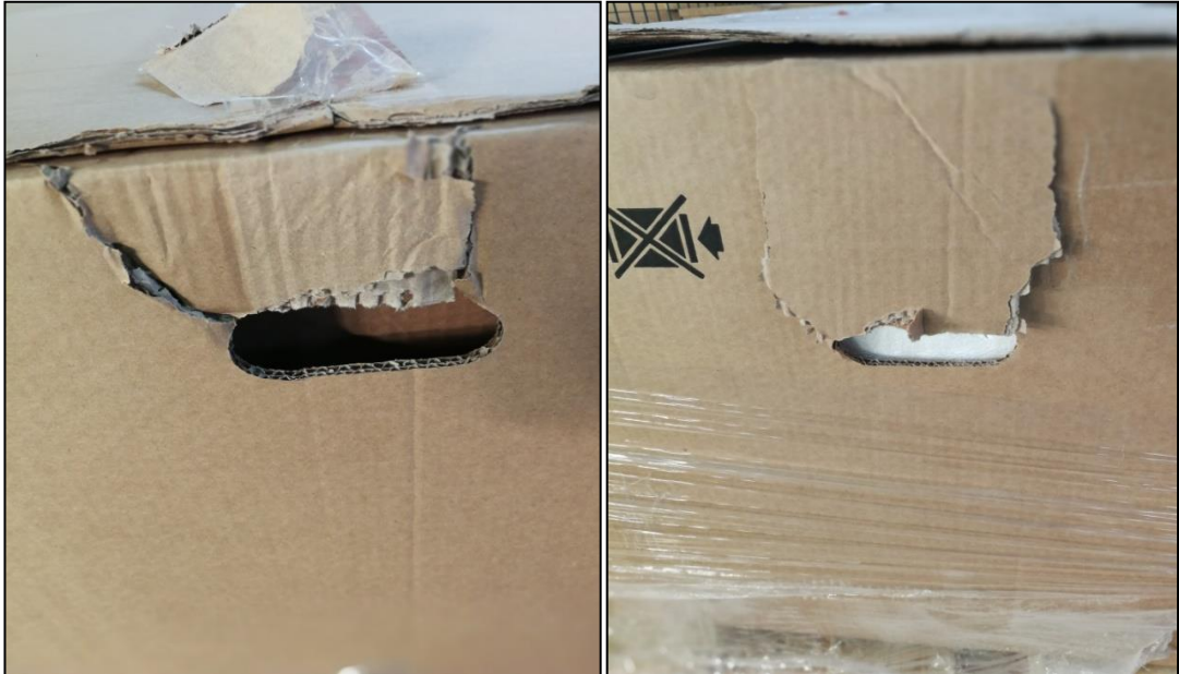
Resim 4. 2. Gerilim sonucu elçek yerlerinden yırtılan kutular
