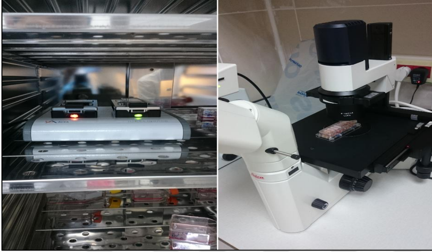
Resim 3.4. RTCA iCELLigence cihazı ve interted mikroskopta incelenen mikroelektrotlu plaka
